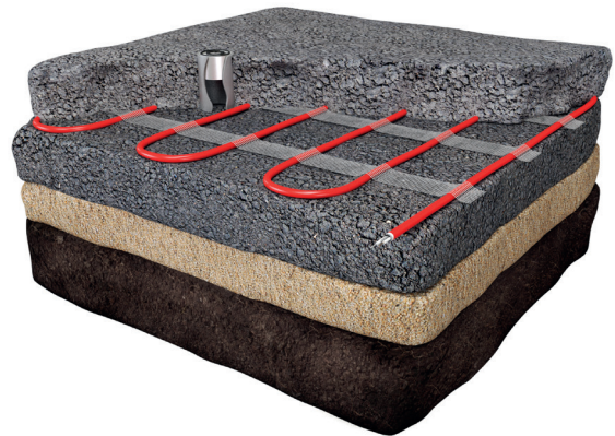
Installatie in ongewalst asfalt
